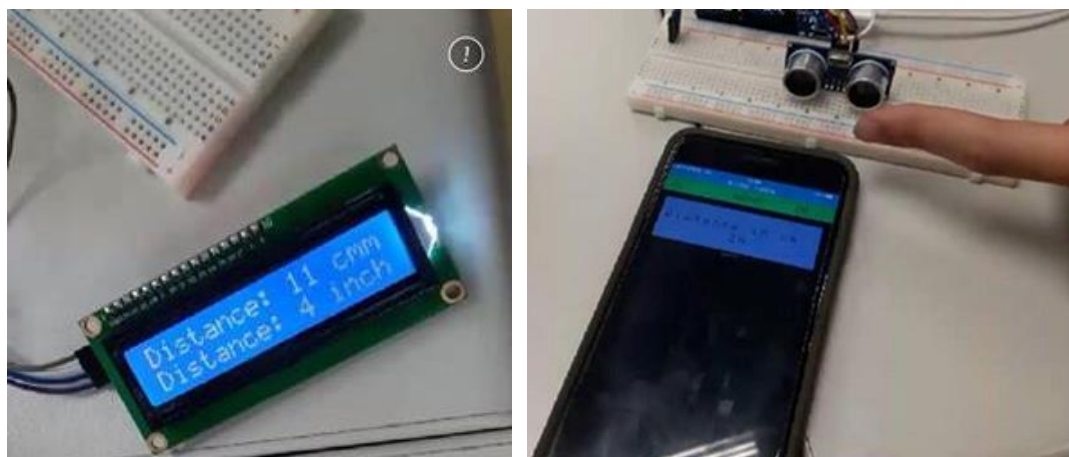
圖三、超音波測距儀結合 LCD 面板顯示距離，並以 Blynk App 開發與設計顯示距離介面。
