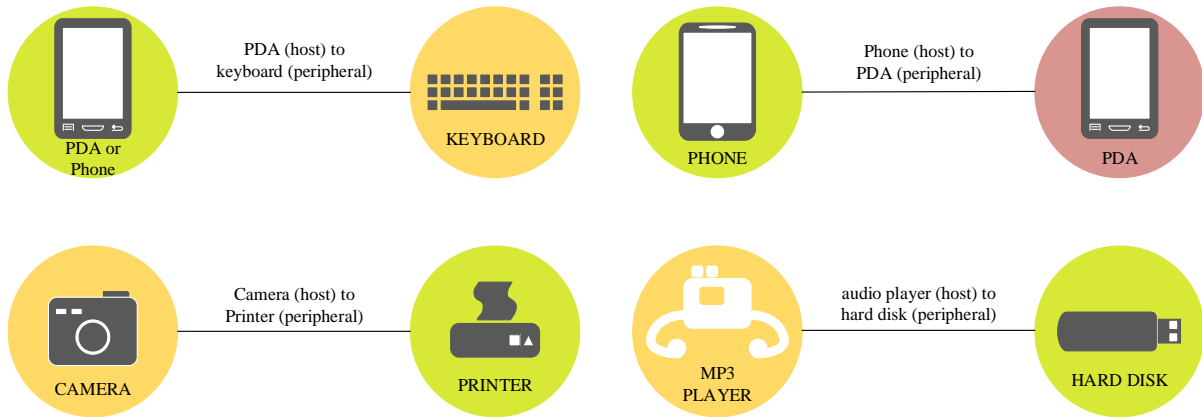
圖 2.5 USB OTG 點對點架構示意圖[ 12 ][ 13 ]
