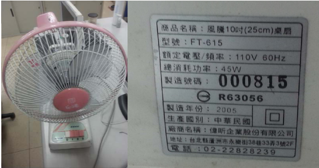
圖 4.4 節能測試使用電風扇與消耗功率
