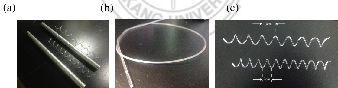
圖 4-2-4 螺旋型檔板(a)模具(b)檔板製作之壓克力條(c)螺旋型檔板實際圖
