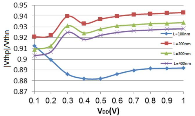
Fig. 7.  $|V_{thp}|/V_{thn}$ ,  $W_p=560nm$ ,  $L=100nm, 200nm, 300nm,$  and  $400nm$ .
