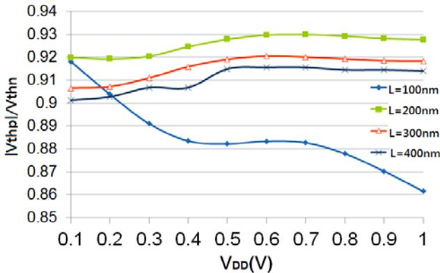
Fig. 6.  $|V_{thp}|/V_{thn}$ ,  $W_p=450nm$ ,  $L=100nm, 200nm, 300nm,$  and  $400nm$ .
