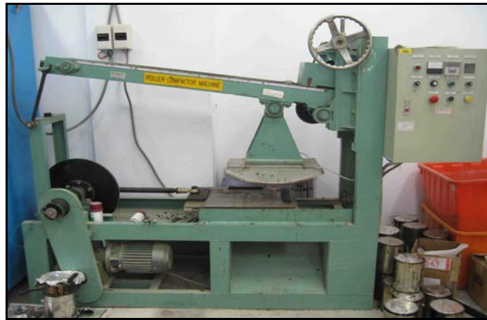
圖 3.2 車轍輪跡試體滾壓機
