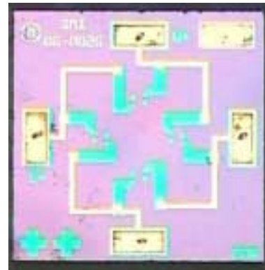
圖四：應用於本計畫之 SMI 感測器晶片面積在 1.8mm 見方。
