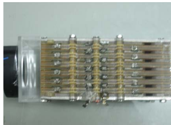
圖二 A: 燃料電池組合圖，顯示空氣流道入口及抽風扇(圖左側)
