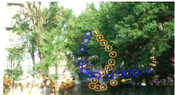
圖14 拍翼式微飛行器之飛行軌跡，標示軌跡約飛行4秒，97年3月(合成圖)。
