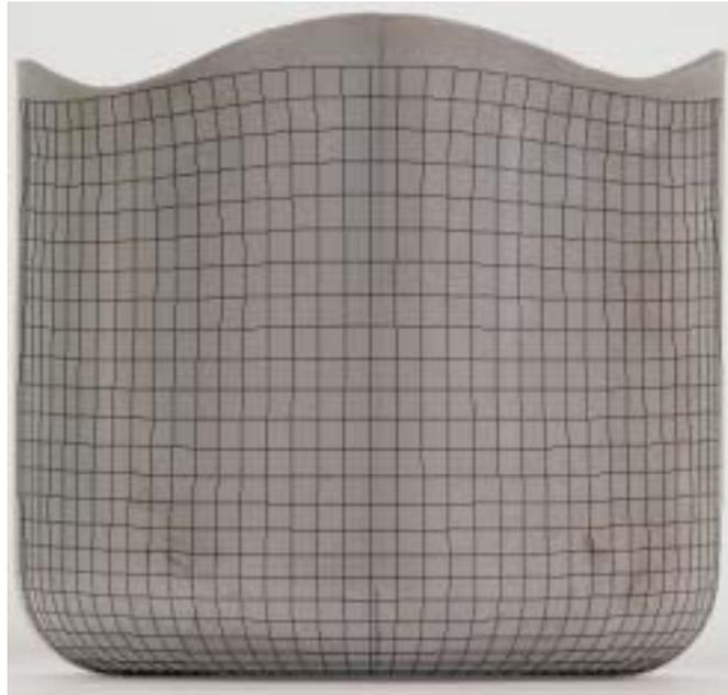
圖 6-10 擷取成形工件之數位影像與數值分析結果套疊比較
