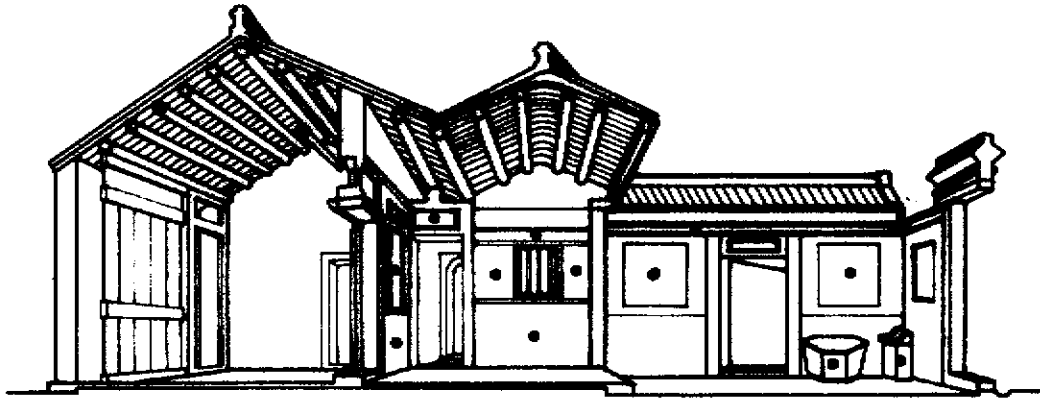
圖 4-24 澎湖地方傳統民居建築—剖透圖（紅點部位為馬約利卡磁磚施作部位）
