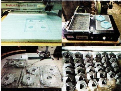
圖21 植生亭「巢居」以數位車床與真空成型機製作過程
